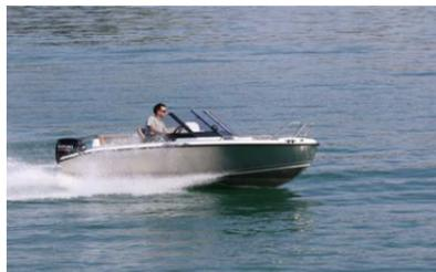
Bien qu'il soit le plus petit modèle de Silver, le Fox BR 495 reste cependant stable et précis sur l'eau. Outre la forme de la coque, la double coque résistante à la torsion a également un impact positif sur les caractéristiques de conduite. Remplie de mousse, elle garantit d'une part l'insubmersibilité du bateau et, d'autre part, elle permet d'absorber la majeure partie de la force lors d'un choc.
