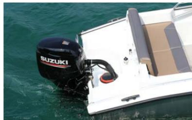
En Suisse, tous les bateaux Silver sont équipés d'un moteur 4-temps signé Suzuki. Pour le Fox BR 495, l'importateur Alex Buholzer a opté pour les 60 cv recommandés par le chantier naval. Cette motorisation s'est avérée judicieuse lors de notre test et a permis d'atteindre avec deux personnes à bord une vitesse maximale très agréable de 50 km/h. Rien à redire donc.
